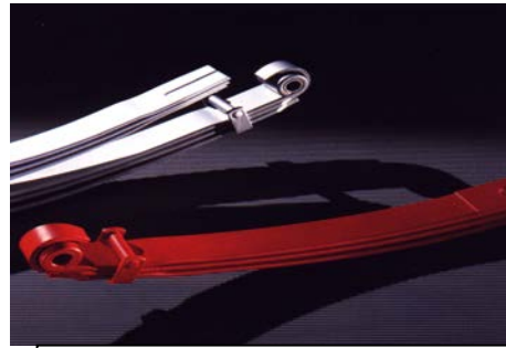
Balestre paraboliche multilama per veicoli commerciali pesanti
