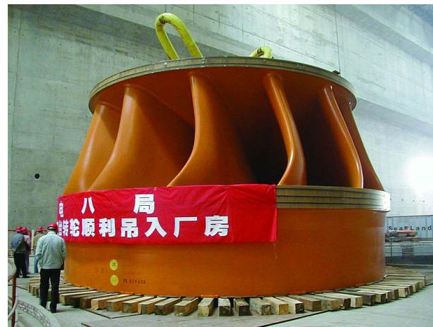
Turbina Francis da 700 MW
