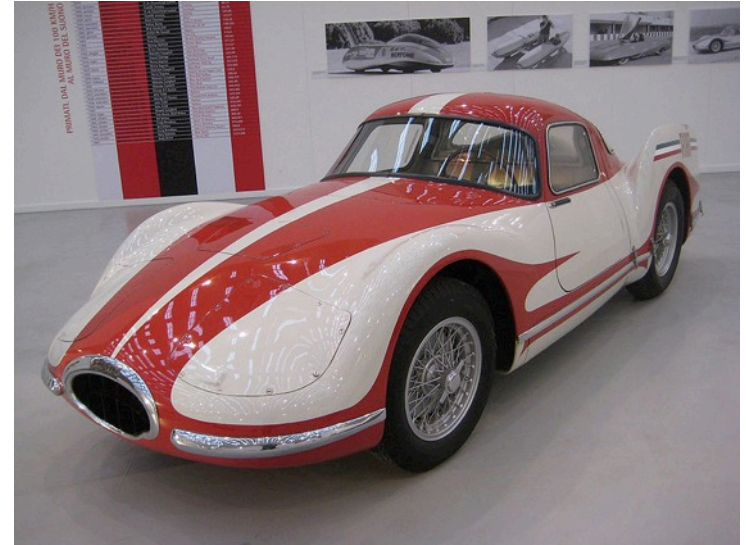
Fiat Turbina, concept car del 1954, con propulsione tramite turbina a gas ( c_x=0,14 )
