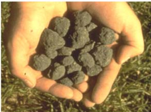
Immagine di un clinker e sua micrografia
