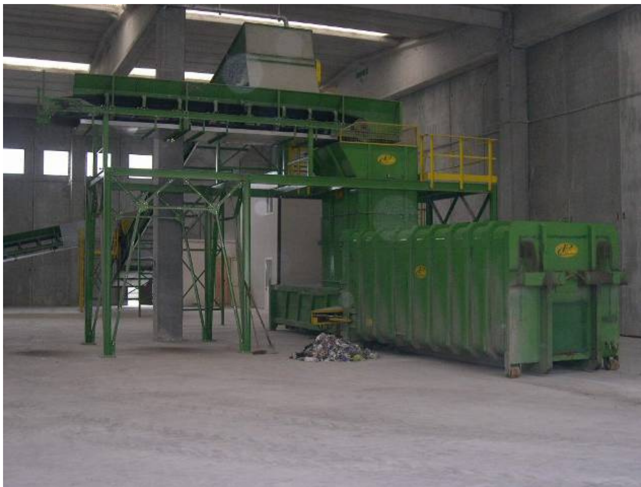
Cassone pressa per il trasporto delle frazioni secche selezionate
